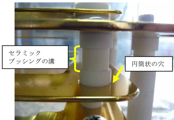
写真 1 : IPM 電極の拡大写真
