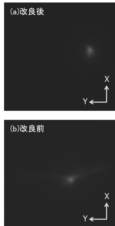
図 5：(a)磁石改良後の X 線プロファイル(ビーム条件 60 keV、3 mA)。(b)改良前の低パワー時の X 線プロファイル(ビーム条件 60 keV、12 mA)。低パワー時は収差による影響が小さいが、明らかに収差が見られる。
