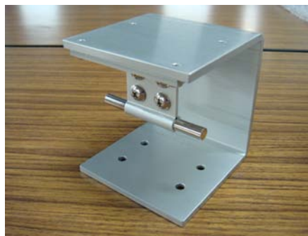
図4: 固定標的(上がNi54mm実効長、下がPt \phi 6mm-L60mm)
