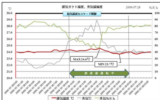
図8：排気ダクト温度
