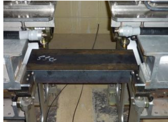
図 17：ユニット間に設置された渡し板
