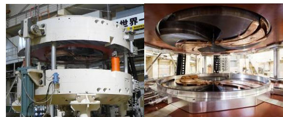
図 2 : P235 サイクロトロン の外観(左)、内部(右)
