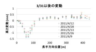
図5:地震後からの床高さ変動結果
