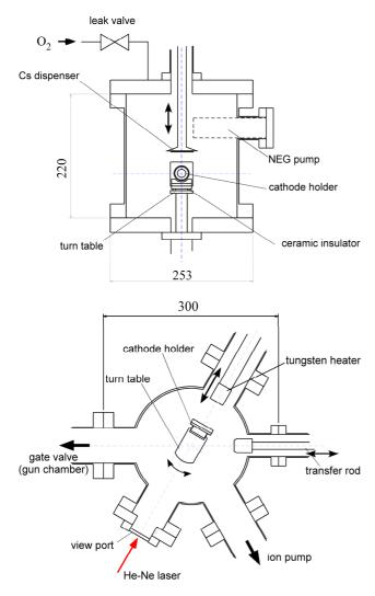
図1:新光陰極試験装置、プリパレーションチェンバーの概略図。(上):ビューポートから見た断面図。(下):上部から見た断面図。
