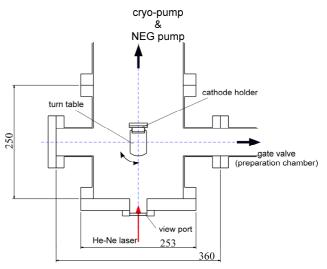
図2:新光陰極試験装置、ガンチェンバーの概略図 (上断面)。
