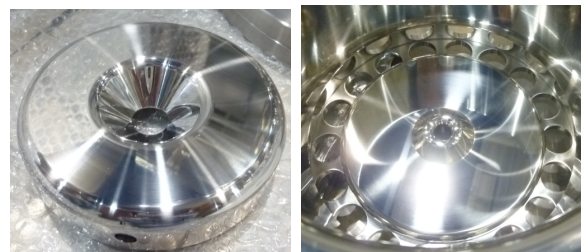
(a) ウエネルト (b) アノード 図 5: ウエネルト及びアノード表面は放電対策の為、鏡面仕上げとなっている。
