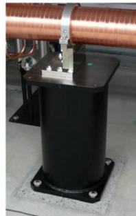
図 10. Cバンド加速管用架台。
