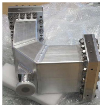
図 3: A6063 製 WR650 導波管の例。E ベンドビューポート付き。引き抜き管（厚み 5mm）を TIG 溶接により接合。EBW による接合試作も行なっている。
