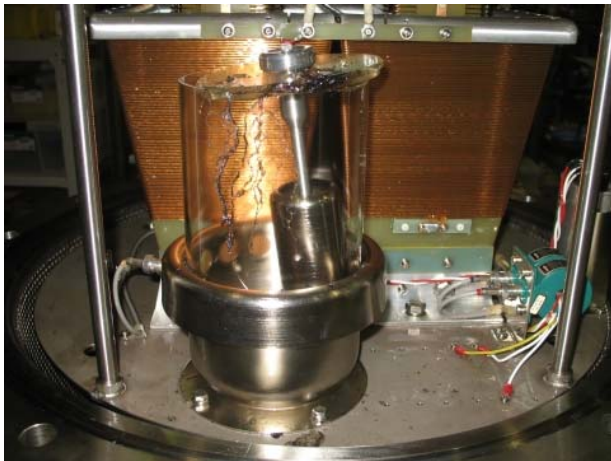
図 2：短絡した容量分圧器
