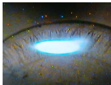
図 4：U ビームが照射され光る CNT-SDC-foil。ビームサイズは約 5mm x 10mm の楕円形。
