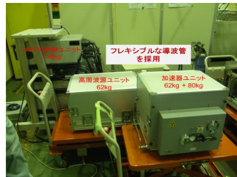
図 3. 可搬型 3.95MeVX バンドライナック X 線源
