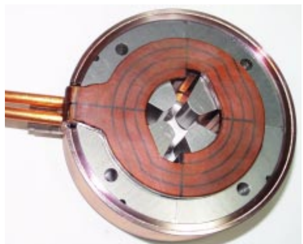
図 1 D T 用冷却水ジャケットで焼ばめ後の写真
